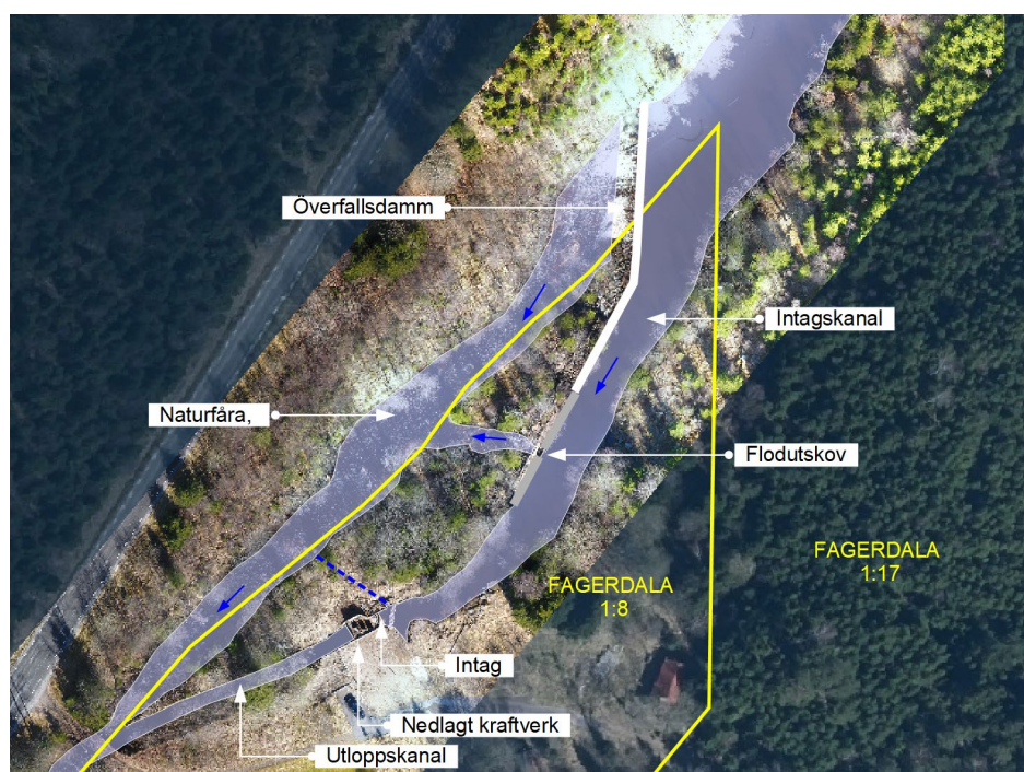
Figur 2. Översikt av anläggningsdelar vid Fagerdala kraftverk.
