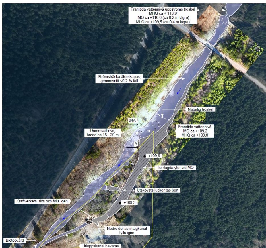
Figur 4. Dammen öppnas upp och förlorar sin dämmande effekt. Vattennivån sänks och naturlig strömsträcka ovan dammen återskapas.
