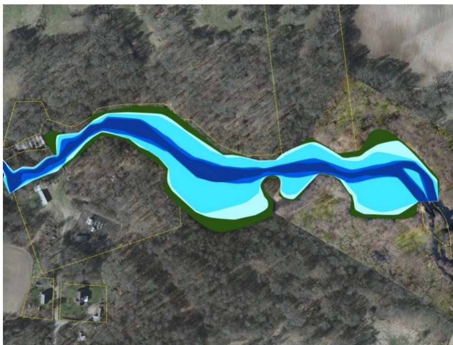
Figur 10. Vattenytans utbredning längs det av åtgärden påverkade området uppströms Ekforsdammen. Mörkblå är vid lågvattenföring och ljusblå vid högvattenföring. Se bilaga 05 för mer utförlig illustration med beskrivning.
