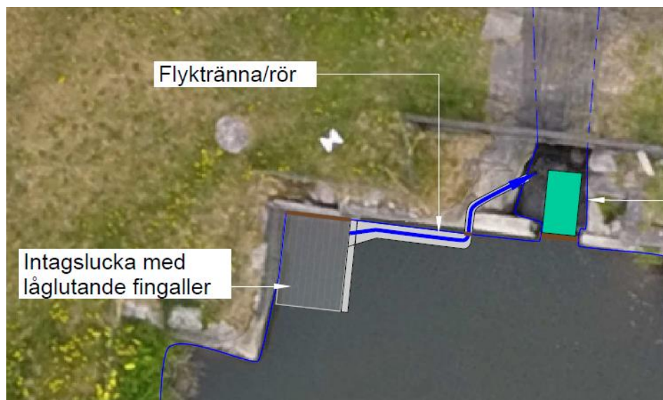
Figur 15. Flyktöppning och flykträna anläggs för att möjliggöra nedströmspassage.
