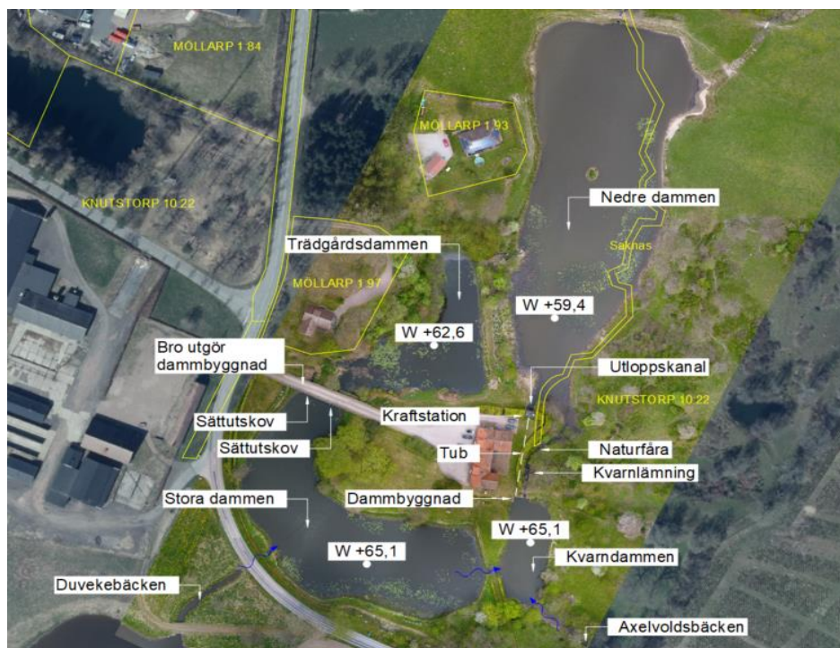
Figur 2. Översiktspild av anläggningsdelar vid Möllarps kraftverk.
