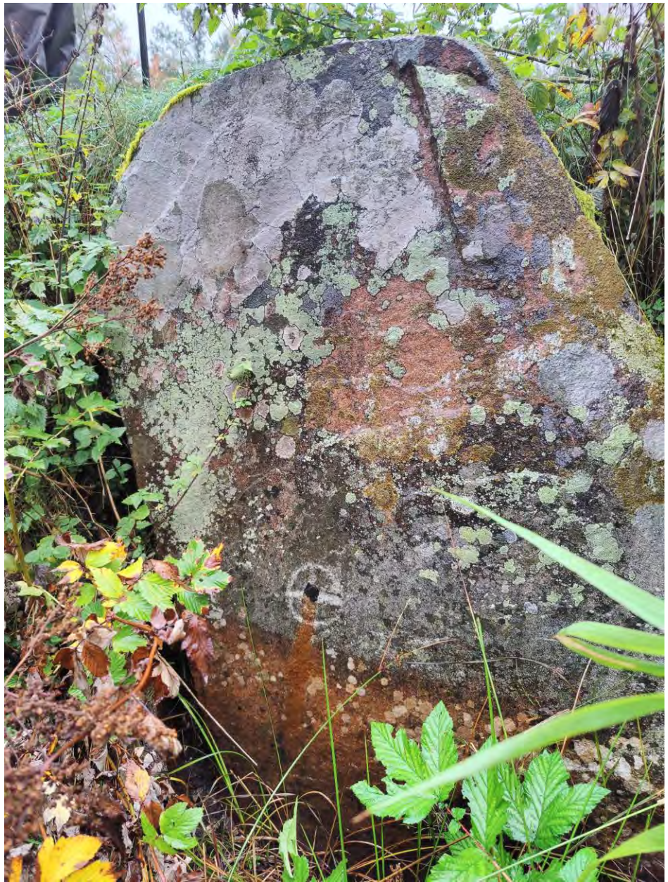
Figur 2. Fixpunkt vid Belganet Mellan, nivå +79,45 i ett lokalt höjdsystem.
