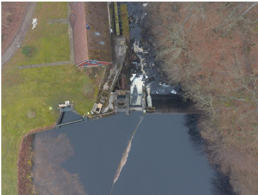
Figur 1. Anläggningen består från vänster till höger av: intag till ny kraftstation, blockerat kvarnintag, intag till äldre kraftstation, flodutskov och skibordsdamm.
