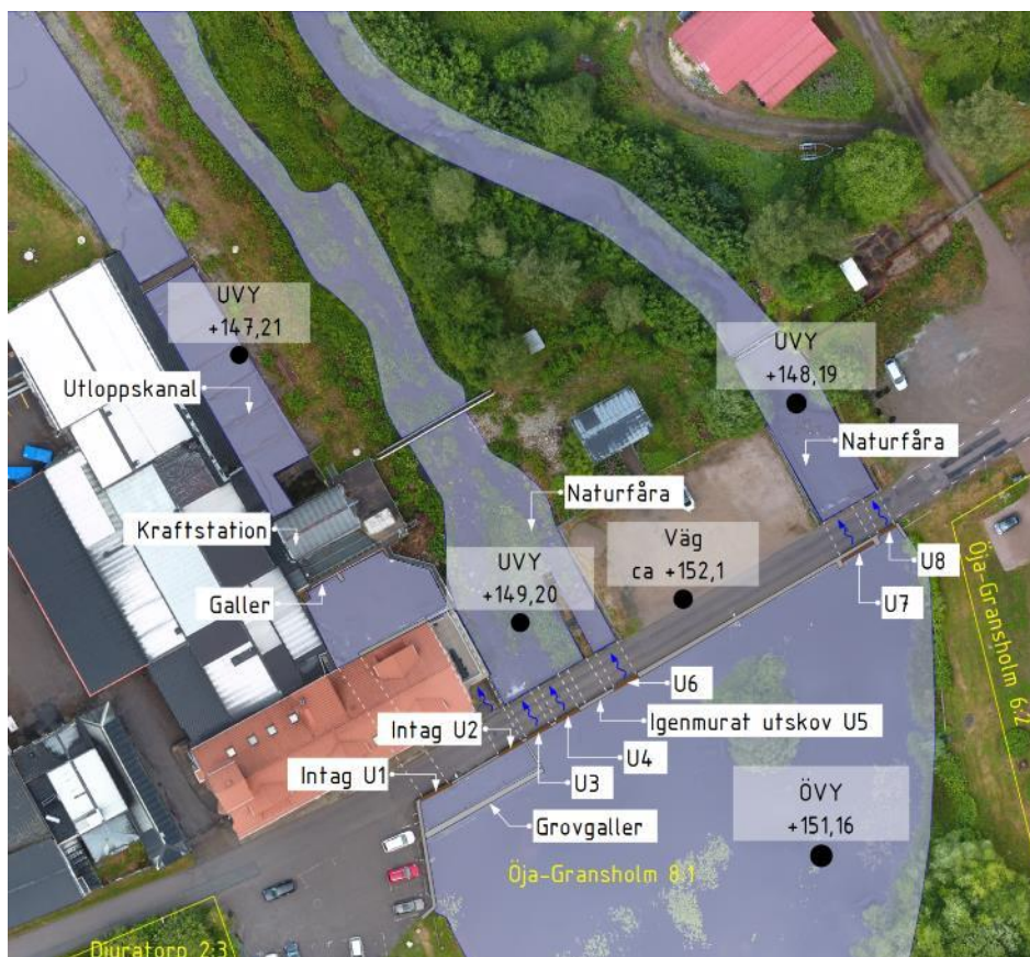
Figur 3. Översikt över dammbyggnad och kraftstation vid Gransholm.
