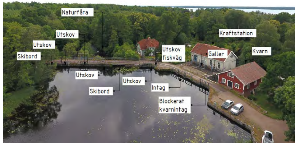
Figur 3. Översikt över Ohs kraftstation.
