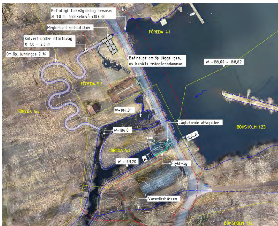
Figur 23. Fiskvandring förbi Böksholm övre möjliggörs med hjälp av ett omlöp och ett reglerbart slitsutskov.
